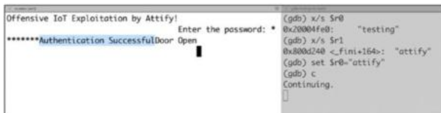
Şəkil 9.25. JTAG Debugging ilə autentifikasiyanın bypass olunması
